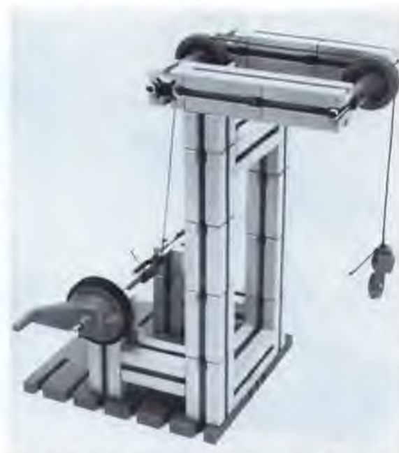
Abb. 1: Einfache Hebevorrichtung mit zwei festen Rollen. Beide Rollen dienen der Änderung der Krafttrichtung, sie ermöglichen das Anbringen der Seiltrommel an einer beliebigen Stelle im Modell. Als „Seiltrommel“ dient hier die Welle, das Seil ist mit einer Klemmbuchse befestigt. Für messende Versuche ist es zweckmäßig, statt der Welle und der Handkurbel direkt einen Kraftmesser anzusetzen; dann wird deutlich, daß die festen Rollen keine Kraftersparnis bringen.
